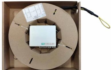
**Scatola di Terminazione Ottica d'Appartamento in plastica, pre-connettorezzato su entrambi i lati, con 4 bussole SC/APC e shooter; disponibile con 30m di cavo da 4 fibre per gli impianti multiservizio FTTH; soluzione molto utile per portare all'interno di ogni singola unità abitativa tutti i servizi centralizzati nel CSOE degli impianti FTTH.**
